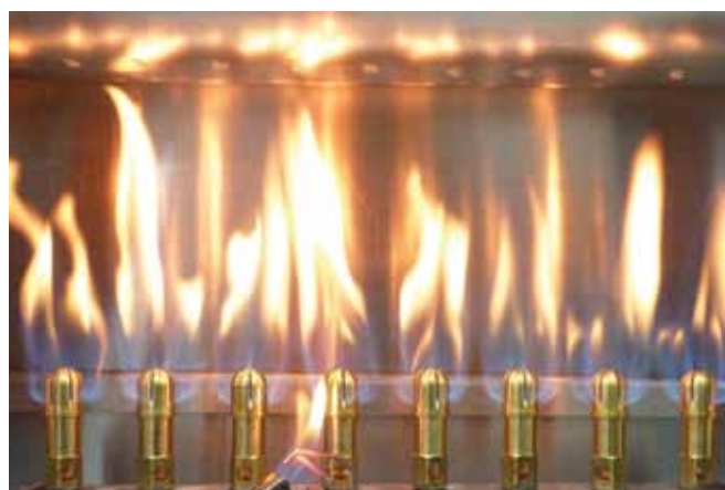
Figure 2 : Exemple de combustion incomplète : flammes jaune orange et souvent vacillantes. Produit des gaz toxiques comme le monoxyde de carbone, l'éthylène et le dioxyde de soufre.
